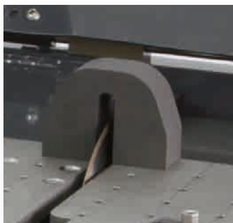
Mode coupe métallographique pour la coupe de petits échantillons
