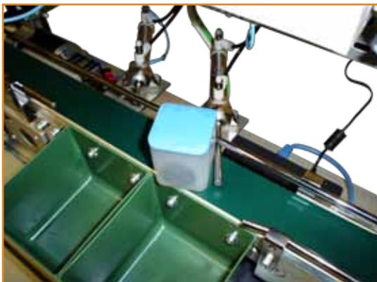
LOG-200 permet de connaître l'information contenue dans chaque «tag» au travers du contrôleur RFID et l'API envoie l'information appropriée à chaque actuateur pour déposer chaque récipient à l'endroit correct. De plus, l'accès à l'information de chaque objet pourra se réaliser au travers d'Internet grâce au serveur Web qui communique avec l'API.
