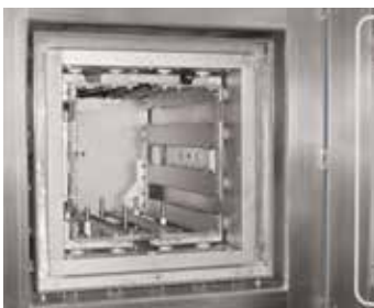
Élément chauffant en molybdène ou en tungstène
