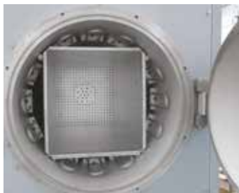
Chauffage intérieur, fours moufle étanche NRA ../06
