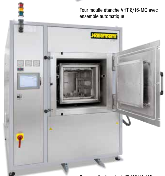
Four moufle étanche VHT 100/16-MO avec ensemble automatique
