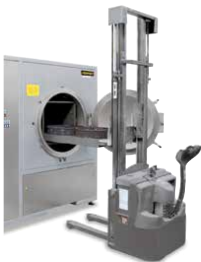
Chargement du four moufle étanche NRA 300/06 à l'aide d'un chariot élévateur
