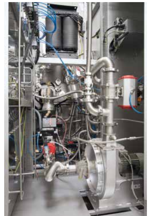
Refroidissement forcé du gaz pour four moufle étanche à paroi froide VHT 8/16-MO
