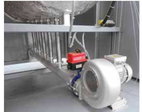
Refroidissement par ventilateur pour four moufle étanche à paroi chaude NRA 400/03
