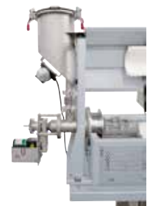
Vibreur sur la trémie de remplissage pour améliorer l'alimentation des poudres
