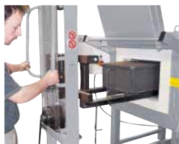
Travail avec caisson d'alimentation en gaz pour atmosphère gazeuse protectrice à l'aide d'une navette de chargement
