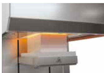
Sole mobile avec arrivée d'air réglable
