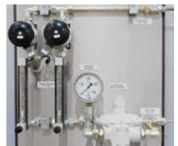
Système d'alimentation en gaz pour gaz protecteurs ou réactifs non combustibles
