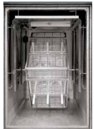
Dispositif rotatif à servomoteur avec des corbeilles en place pour faire tourner la charge pendant le traitement thermique
