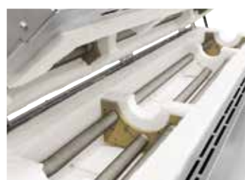
Four tubulaire RSH 120/1000/11S, 3 zones de chauffes comprenant des séparateurs de zone pour atteindre un gradient de température
