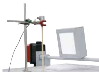
Trappe d'évacuation d'air et thermocouple de charge avec pied comme option
