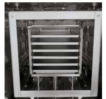
Caisson insert en molybdène avec six supports de chargement
