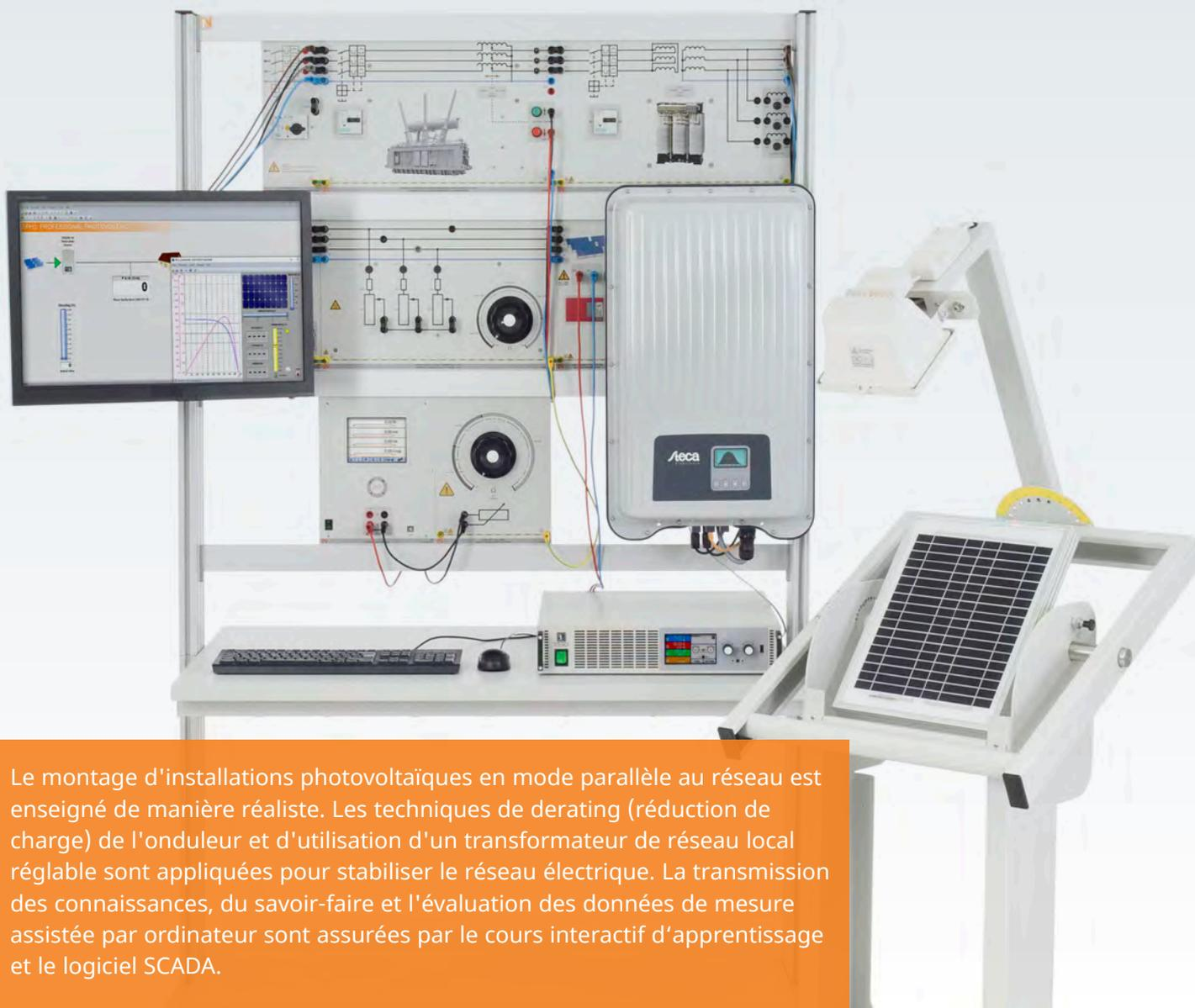
Le montage d'installations photovoltaïques en mode parallèle au réseau est enseigné de manière réaliste. Les techniques de derating (réduction de charge) de l'onduleur et d'utilisation d'un transformateur de réseau local réglable sont appliquées pour stabiliser le réseau électrique. La transmission des connaissances, du savoir-faire et l'évaluation des données de mesure assistée par ordinateur sont assurées par le cours interactif d'apprentissage et le logiciel SCADA.
