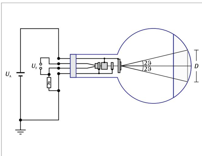
Fig. 1 Représentation schématique des tubes de diffraction d'électrons
