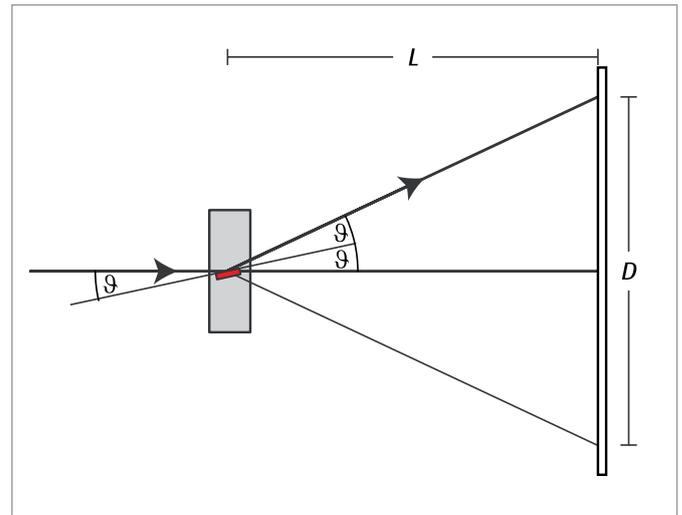
Fig. 2 Réflexion de Bragg sur un ensemble « adapté » de plans réticulaires d'un cristal sélectionné sur un film graphite
