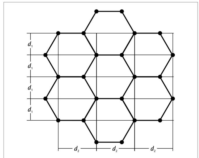
Fig. 3 Structure cristalline du graphite
